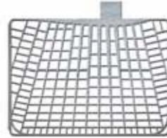
Red eléctrica estampada completamente enmarcada ayuda a prevenir cortocircuitos y aumentar el flujo eléctrico. Mejora la carga con un 66% más de resistencia a la corrosión\*
